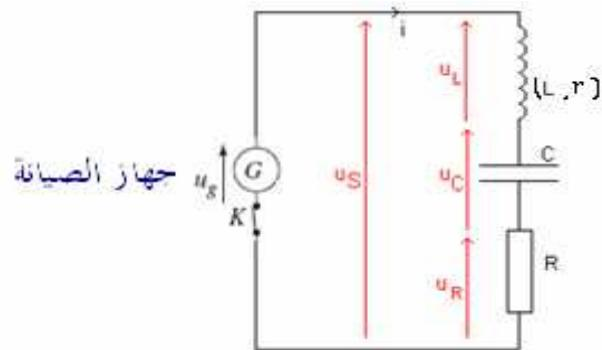
المولد  $G$  يزود الدارة بتوتر يتناسب اطراضاً مع شدة التيار الكهربائي الذي يعبر الدارة. (مع  $R_o = R + r$  ) (مع  $u_g = R_o \cdot i$ )
