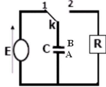
1) نضع قاطع لتيار الكهربائي في الموضع (1) عند اللحظة  $t=0$  (أ) ما الهدف من هذا التركيب؟
