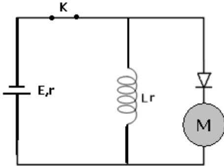
ب – الصمام مركب في المنهي غير المباشر وبالتالي فلا يسمح بمرور التيار الكهربائي في المحرك .
