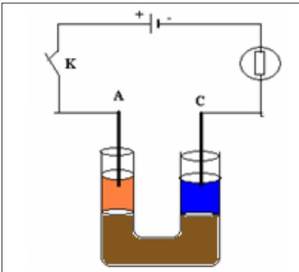
عند غلق الدارة بواسطة قاطع التيار نلاحظ هجرة الأيونات حيث أيونات النحاس II الزرقاء اللون تنتقل نحو الكاثود و أيونات ثنائي كرومات  $Cr_2O_7^{2-}$  البرتقالية اللون تنتقل نحو الأنود نستنتج أن التيار الكهربائي في الإليكتروليتل هو انتقال الأيونات ، حيث الكاثيونات (الأيونات الموجبة) تنتقل نحو الكاثود و الأنيونات ( الأيونات السالبة ) تنتقل نحو الأنود .
