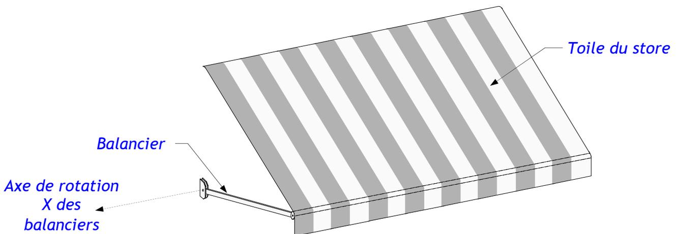
☞ *L'opérateur tubulaire (LT 50)* permet, grâce à un fonctionnement dans les deux sens de rotation, de monter ou descendre le store.
