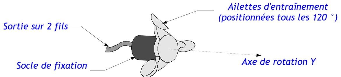
☞ **Le capteur soleil** est constitué d'une photodiode BPW34.
