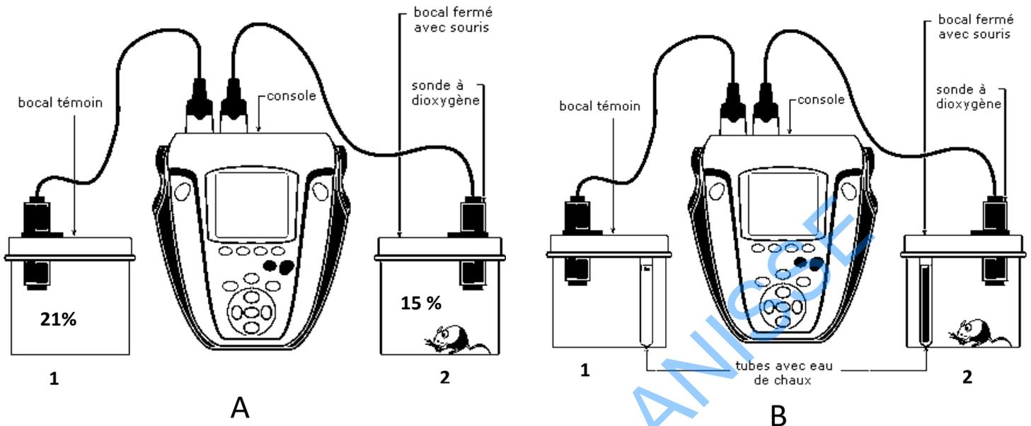
L'animal (souris) est placé dans une enceinte hermétiquement fermée contenant une sonde à dioxygène associée à un appareil de mesure d'oxygène
