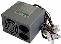
خاصة بإمداد التيار الكهربائي اللازم لأجزاء الحاسوب بالجهد والتيار المطلوبين.
